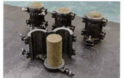
モールドを用いて固めた供試体 3水準の添加量で作成します
