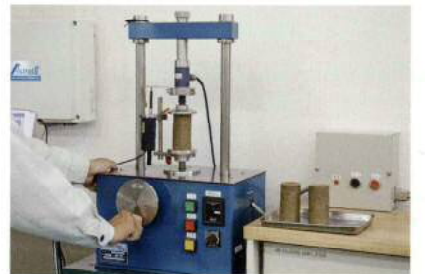
供試体を一軸圧縮強度試験機にかけ、 データを取得します
